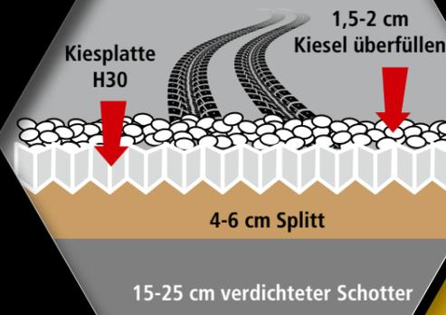
Diese **Kiesplatte** kann mit Hand- oder Stichsäge passgenau zugeschnitten und lückenlos an Hindernisse gelegt werden. Die Waben mit **Kiesel verfüllen**, mit einem **Rechen nivellieren** und dann noch eine Kieselsschicht auflegen. Die Matten sollen **immer vollständig mit Kiesel bedeckt** sein.
