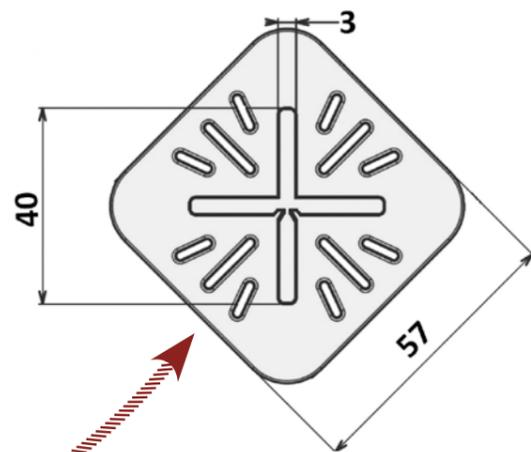
Der transluzente Abstandhalter ist sehr flexibel einsetzbar, wie die Grafik auf Seite 63 zeigt. Er sorgt bei regelmäßiger Verlegung für ein gleichmäßiges Fugenbild; für die versetzte Verlegung kann ein Teil des Fugenkreuzes weggebrochen werden, für die Verlegung an der Wand kann die Basisplatte diagonal gebrochen werden:
