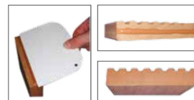
Hirnholzversiegelung in Form einer Raupe auftragen und mit einer Kunststoffspachtel glätten. So werden Austrocknung und Risse vermieden.
