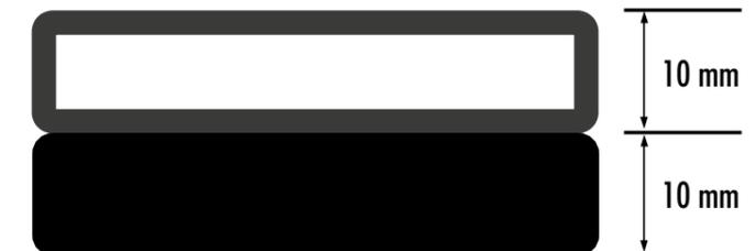
Die versetzte Anbringung der EPDM-Distanzen ermöglicht den Einbau der Schienen sowohl längs als auch quer zur Wasserfließrichtung.
