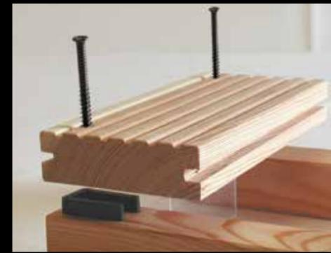
Anfangs-/Abschlusskomponente als Abstandshalter unter die erste Diele setzen. Der Quersteg muss nach oben zeigen. Anfangsdielen vorbohren.
