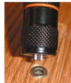
Der **Terrassenmeister®** Bithalter ist vor allem bei Weichhölzern ein sehr nützliches Werkzeug. Man erreicht damit sehr leicht die vorher festgestellte und definierte Einschraubtiefe. Diese kann dem jeweiligen Schraubenkopf stufenlos angepasst werden.
