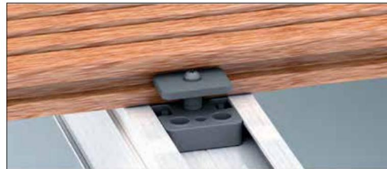
Dielen mit Nut werden mit dem TUKON-System-Clip Holz montiert. Er sichert einen regelmäßigen Abstand von 7 mm, die Adapterhöhe kann angepasst werden. Die Schrauben sind unsichtbar. Nicht für Tropenhölzer (Harthölzer) verwendbar.
