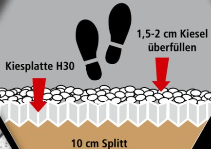
Je nach Bedarf **Einfassung aufbauen** und den **Untergrund so vorbereiten**, dass er sehr stabil und gut verdichtet ist. Splittschicht exakt nivellieren, Fremdkörper (z.B. Kiesel) entfernen. **Dieser Schritt ist sehr wichtig, damit die Kiesplatte ihre Funktion erfüllen kann.**
