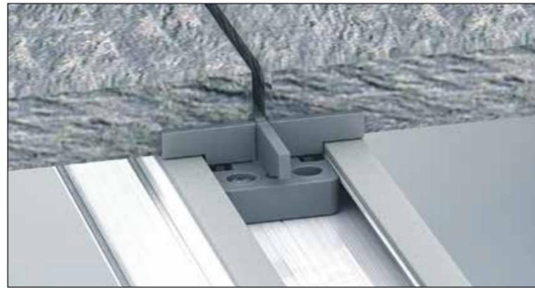
Montagetipp: Akustiktape rechts und links aufkleben, Plattenmaterial auflegen, System-Clip einklicken und festschrauben. So wird das Wandern der Platten verhindert. Das Fugenkreuz hat vorgefertigte Sollbruchstellen, so dass flächenüberstehende Seiten abgetrennt werden können.
