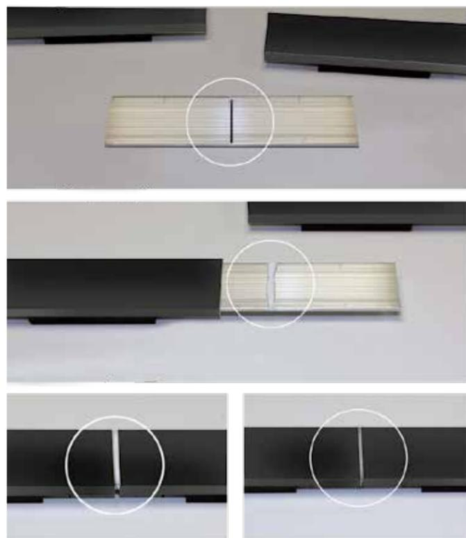
Die Längsverbinder verbinden die Schienen miteinander. Sie werden zur Hälfte in das Rechteckprofil der Schiene gesteckt. Auf die beiden mittigen Markierungen wird eine ca. 3 mm lange Klebstoffraupe aufgetragen (ferax® Kleben+Dichten). Die beiden Schienen zusammenschieben – fertig. Kleben und Versiegeln der Schnittstelle in einem Schritt. Kein Verschnitt – kein Abfall. Verschraubungen sind auch im Stoßbereich möglich.
